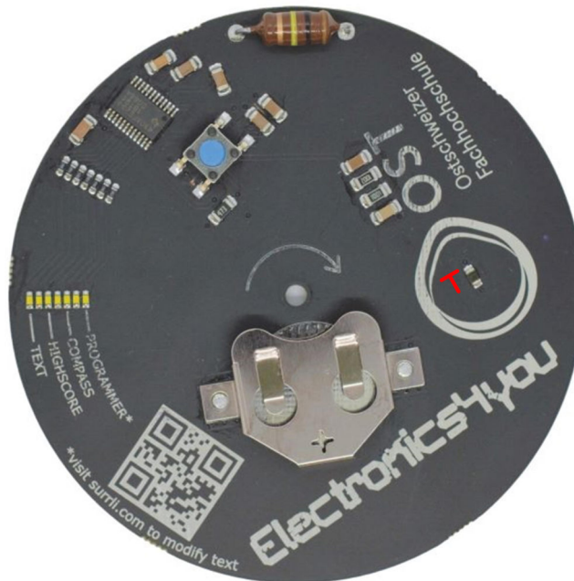
Abbildung 2: Bestückung Phototransistor ACHTUNG: Das 'T' ist auf der UNTERSEITE des Bauteils!
